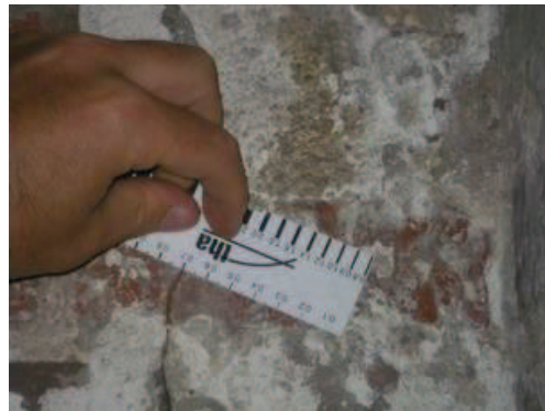
Detail Rissbreite 0,7mm auf Höhe 1,87m
