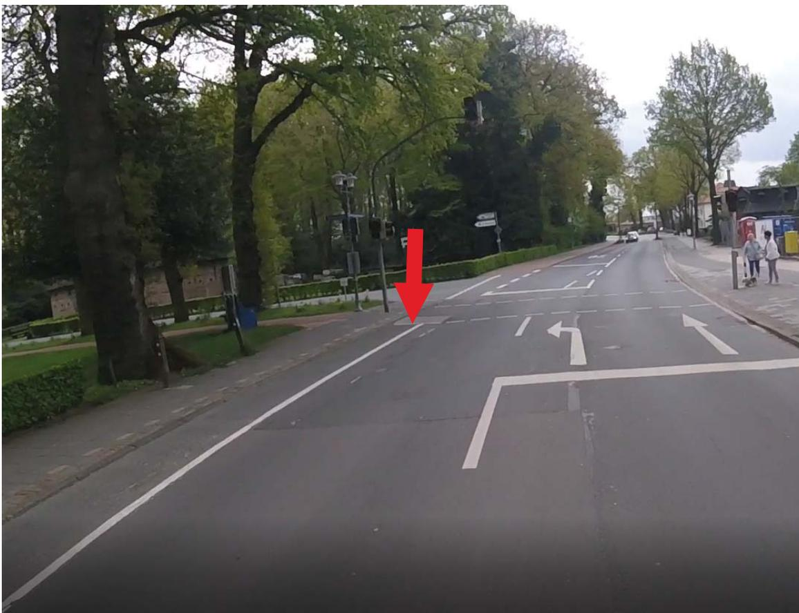
Der Mehrzweckstreifen ist hier deutlich schmaler als im weiteren Straßenverlauf. Die Linienführung wurde nachträglich verändert. Die ist ggf. im Zusammenhang mit der Anlage der Linksabbiegehilfe in Richtung Unter den Eichen erfolgt.
