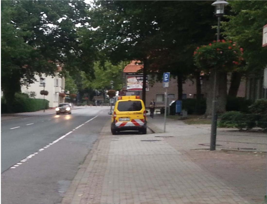
Das Fahrzeug parkt korrekt in der Parkbucht. Diese ist allerdings so schmal, dass das Fahrzeug den Mehrzweckstreifen zur Hälfte in Anspruch nimmt.
