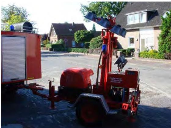
Der oben abgebildete LiMA wurde 1986 für die Ortsfeuerwehr Bad Zwischenahn in Kombination mit einem GW-Z anstelle eines RW 1 beschafft. Es handelt sich um einen mobilen Stromerzeuger mit 25 kVA und einem Lichtmast, der seit 2012 bei der Ortsfeuerwehr Ofen stationiert ist.
